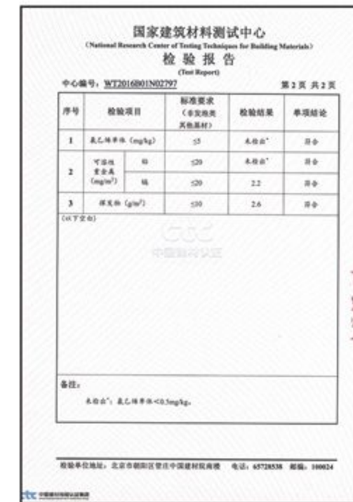
国家建筑材料测试中心经检验，送检样品所检全部项目（聚乙烯单体，可溶性重金属，挥发物）的检验结果符合GB18586-2001
